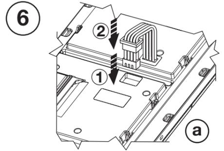
Per la connessione tra moduli appartenenti a telai affiancati, occorre utilizzare il cavetto fornito a corredo del telaio.
